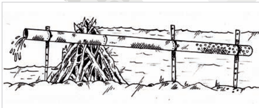
Ryc. 50. STABILIZOWANIE POZIOMU WODY W STAWIE BOBROWYM POPRAZ UMIESZCZENIE RURY PRZELEWOWEJ W TAMIE. Ryc. Wiktor Tabak. Źródło: Bóbr- gryzący problem? Andrzej Czech
